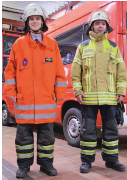
Vergleich der Einsatzjacke „90 Baden-Württemberg“ und der neuen Brandschutzjacke „FIRELINER® 4000 GT Spacer“.
