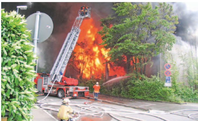
Wenige Minuten später hat die Halle durchgezündet und eine ausgeprägte Wärmestrahlung wird spürbar.
