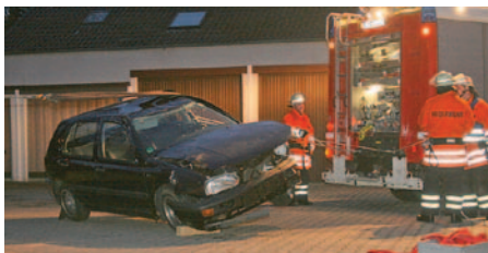
Der PKW muss sanft über die Längsachse gedreht werden.
