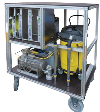
Zusatzbeladung: Zwei Container mit Wassersaugern und Pumpen für Hochwassereinsätze
