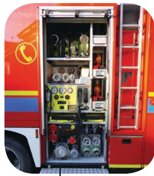
Pumpenbedienstand Am Arbeitsplatz des Maschinisten befinden sich alle Anschlüsse für Saug- und Druckleitungen
