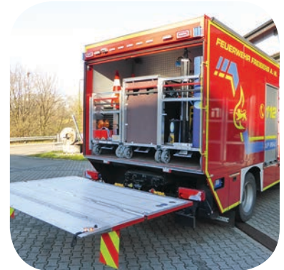
Die Ladebordwand dient zum Be- und Entladen der Rollcontainer: Zum Verlegen der B-Schläuche aus den Containern kann die Ladebordwand auch zur Hälfte umgeklappt werden, damit können die Einsatzkräfte sicher im Fahrzeug stehen und das Auslegen der Schläuche überwachen.
