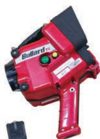
Wärmebildkamera (rechts) für Arbeiten im verrauchten Bereich
