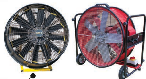
Wasserbetriebener Überdrucklüfter (52.000 m³/h Förderleistung) Elektrobetriebener Überdrucklüfter (14.000 m³/h Förderleistung) zum Belüften von verrauchten Gebäuden. Der wasserbetriebene Überdrucklüfter ist auch in explosionsgefährdeten Objekten einsetzbar.
