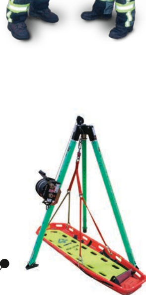
Dreibein mit PROMAN-Winde zur Rettung aus Tiefen Schleifkorbtrage/Spineboard Trage dient zur Patientenrettung
